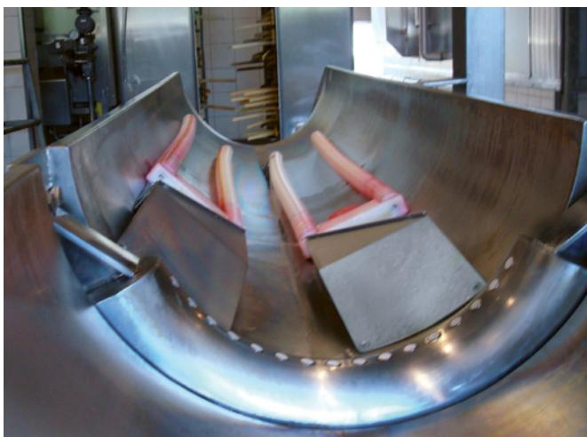
Bügel mit Messköpfen im Messkanal
